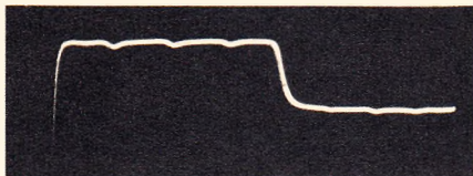
Bild 4b. Wie Bild 4a, jedoch Y-Verstärkung \times 2 . Deutlich sind die einzelnen Antennensteckdosen erkennbar
