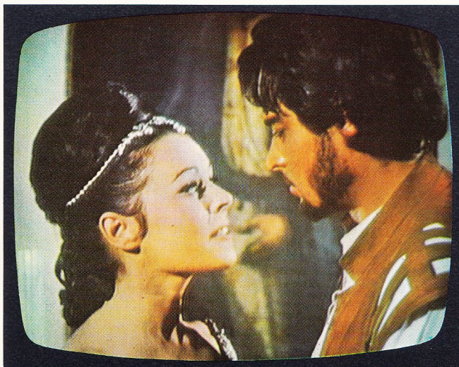
Alle Fotos dieses Beitrages wurden mit Leica M 4, Tele-Elmarit 135 mm, und Minolta SR-T-101, Rokkor 2,8/135 mm, auf Agfacolor CT 18 aufgenommen. Blende 2,8; 1/4 s. Filterung: Gelb 50 + Purpur 40 (50 40 -). Als Empfänger diente ein Nordmende-Farbfernsehgerät. Links: Aufnahme aus der
