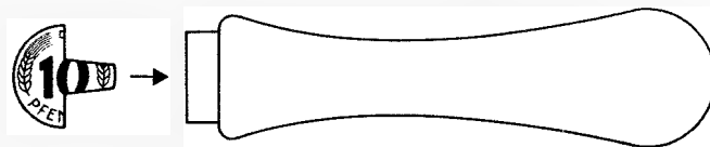
Bild 1. Selbstangefertigtes Werkzeug für Zierschrauben, die üblicherweise mit Hilfe von Münzen gedreht werden
