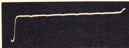
Bild 5c. Gleiches Meßobjekt wie in Bild 5a. Y-Verstärkung \times 5 . Selbst gut angepaßte Dosen ergeben noch durch ihre geringe Fehlanpassung eine sehr deutliche Anzeige
